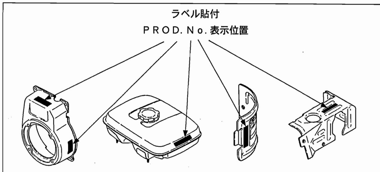
PROD. No. (15桁) のラベルは、ブローハウジング、フューエルタンク、シリンダバツフル、ヘッドカバーのいずれかの見易い位置に貼付してあります。
