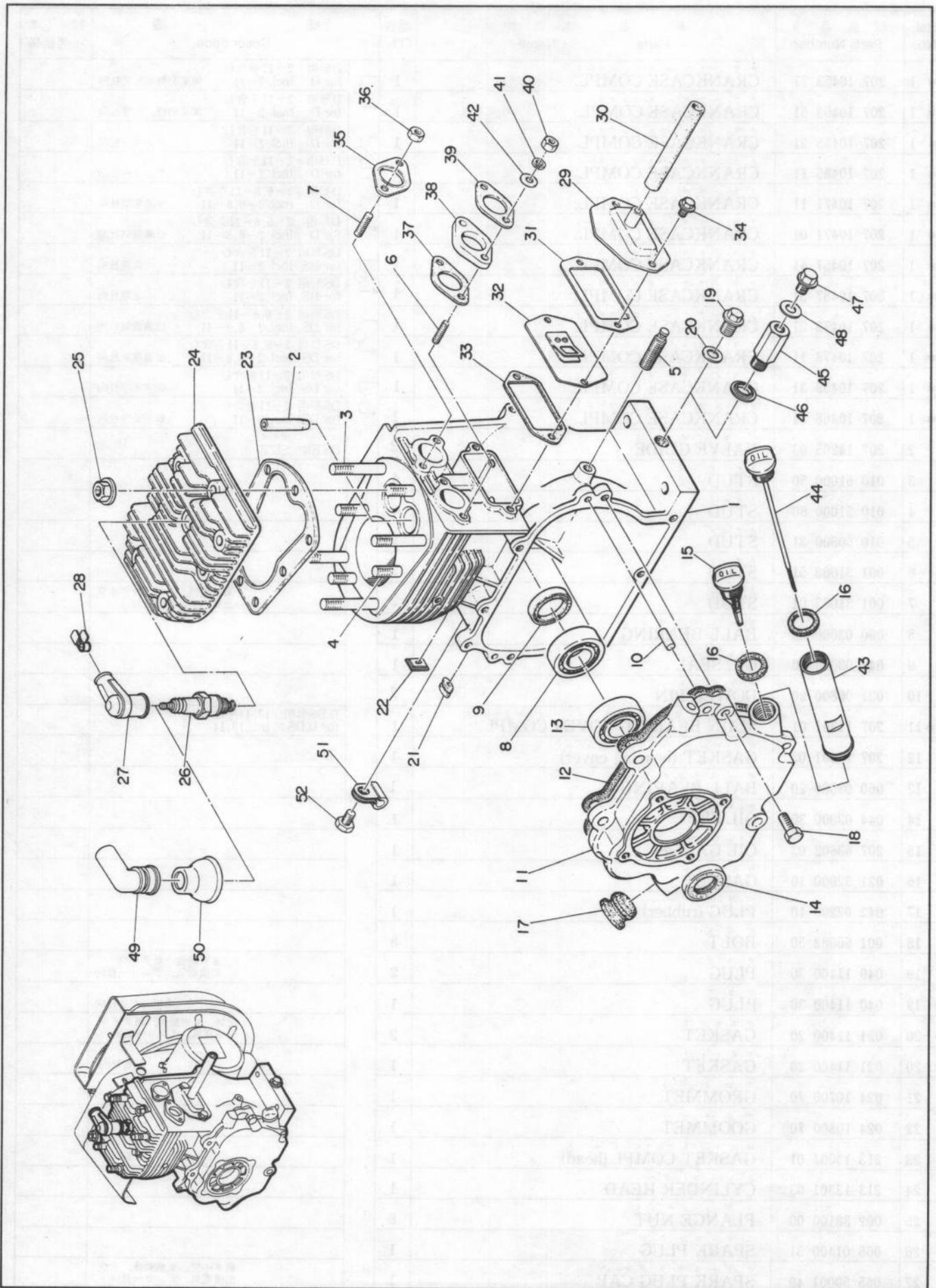
2. クランクシャフト, カムシャフト, ピストン……CRANKSHAFT, CAMSHAFT and PISTON
