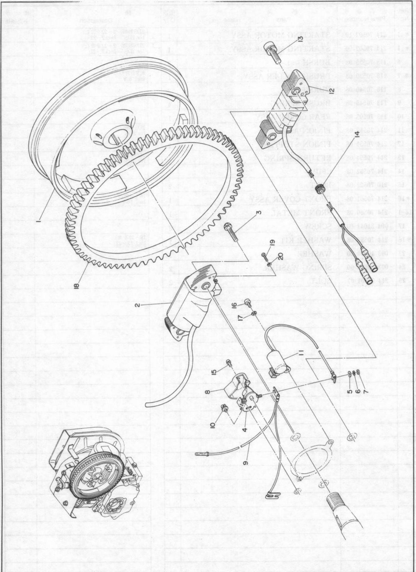
8. マグネット(電子点火装置C.D.I).....MAGNETO(C.D.ignition)
