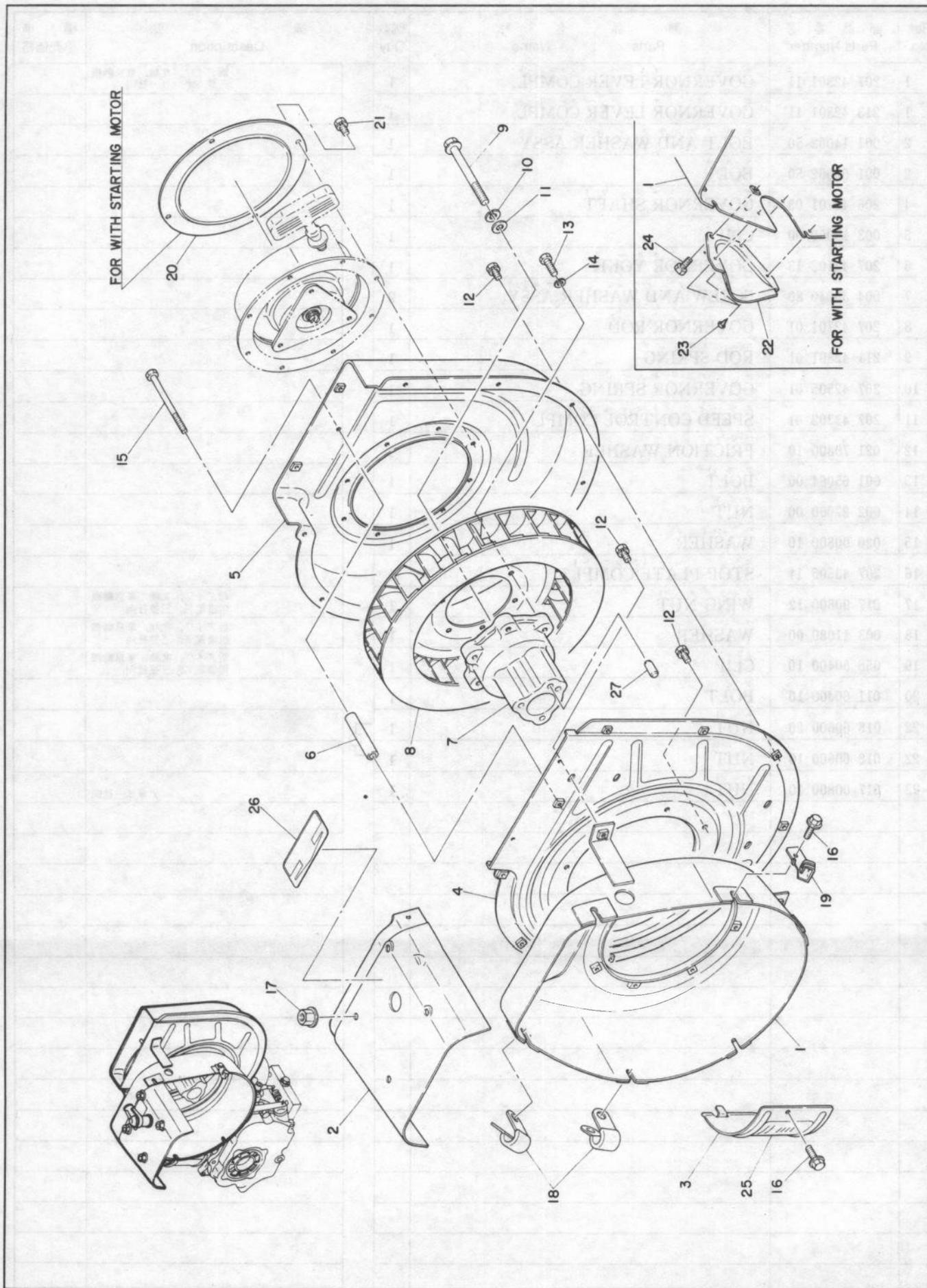
4. ブロアハウジング, クーリングブロア, ダクト……BLOWER HOUSING, COOLING BLOWER and DUCT
