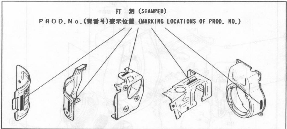
PROD.No.(背番号)15桁は、シリンダーバッフル上に打刻、又はブローハウジングなど見易い位置にラベルの貼付など、いずれかで表示されています。
