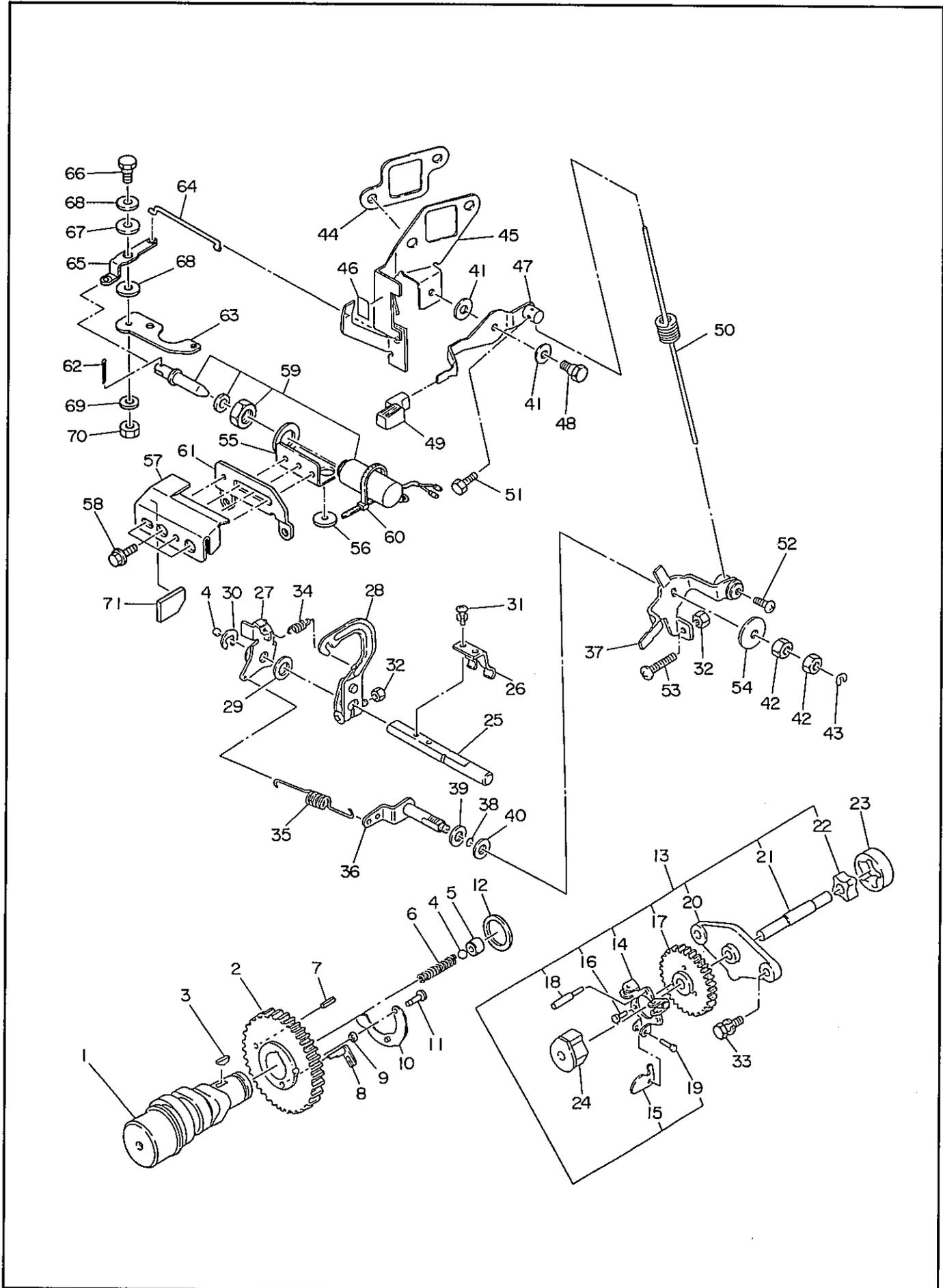
9. フューエル インジェクション ポンプ, ノズル.....FUEL INJECTION PUMP and NOZZLE
