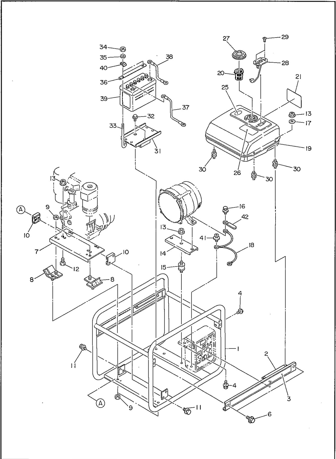
2. パイプ フレーム, フューエル タンク . . . . . PIPE FRAME and FUEL TANK
