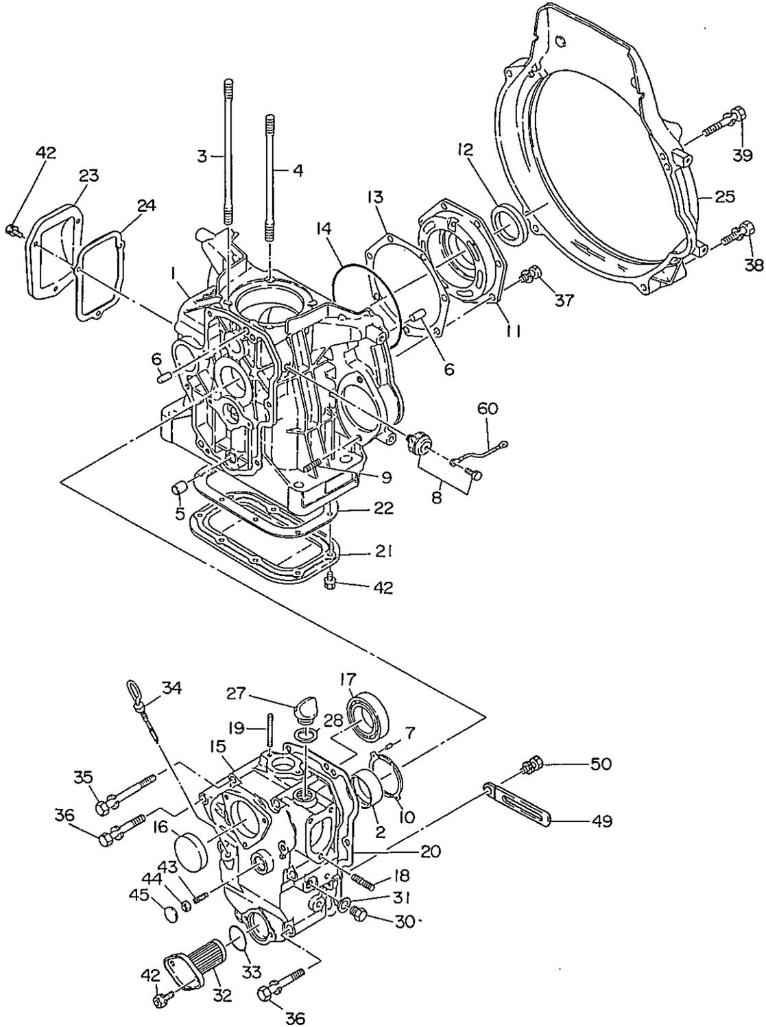
6. シリンダ, シリンダ ヘッド.....CYLINDER and CYLINDER HEAD
